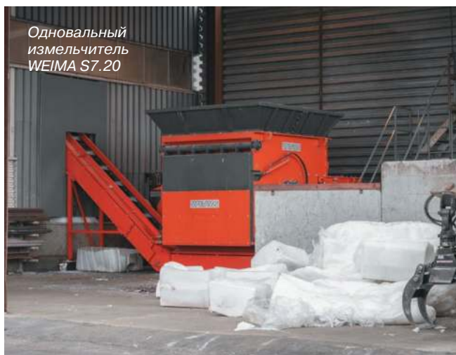
Мощный ротор для переработки крупногабаритных отходов
