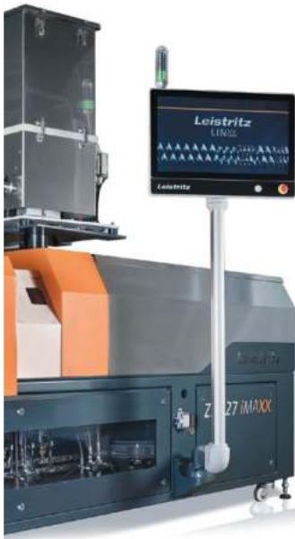
LinXX от Leistritz — система цифрового управления экструдерами и экструзионными системами
